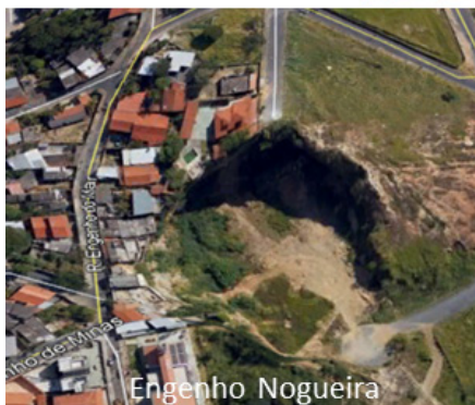
Figura 13. As imagens exibem antigas pedreiras de gnaissse ocupadas inadequadamente. Ocorrem queda de blocos e há risco para as moradias.
