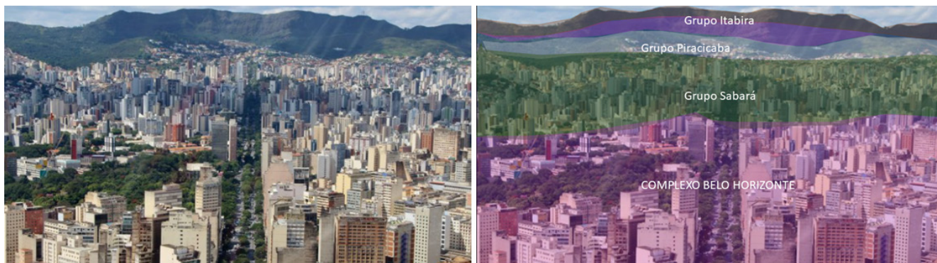
Figura 2. imagem área com delimitação aproximada da abrangência das formações geológicas do município de Belo Horizonte em função do relevo.
